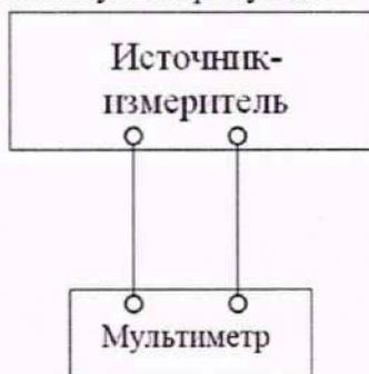
Примечание – В качестве мультиметра использовать мультиметр 3458А (для измерений силы постоянного тока до 1 А включ.) или мультиметр цифровой Fluke 8846А (для измерений силы постоянного тока св. 1 А)
