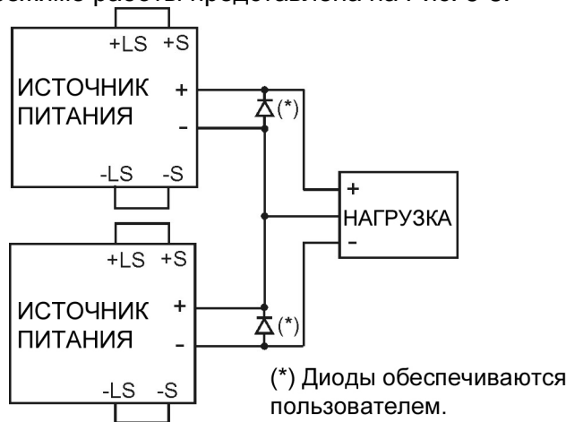
Рис.5-3: Последовательное соединение для получения положительного/отрицательного выходного напряжения
