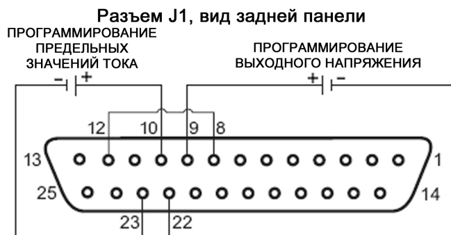
Рис.6-1: Подсоединение внешнего программирования уровнями напряжений
