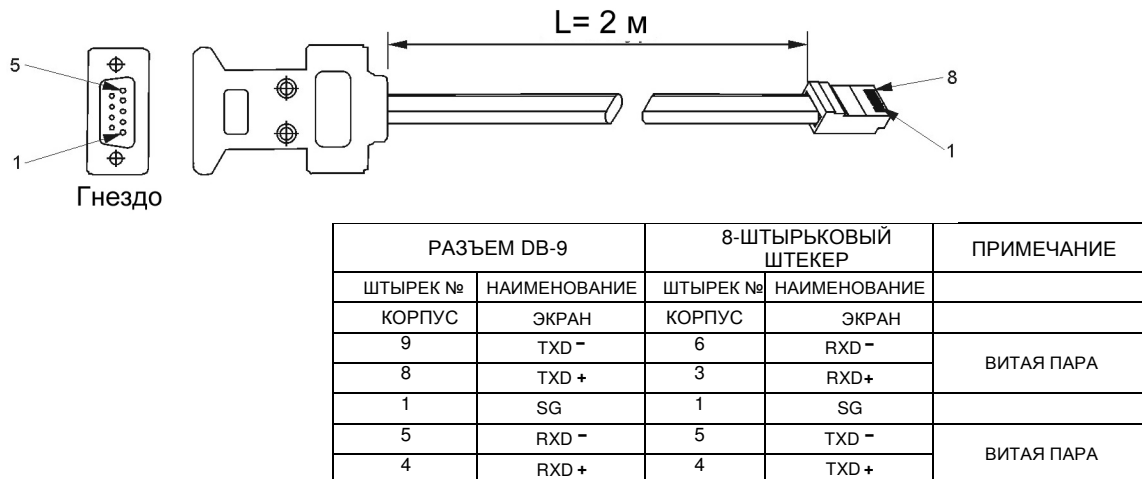
Рис.7-4: Кабель RS485 с соединителем DB9 (P/N: GEN/485-9)
