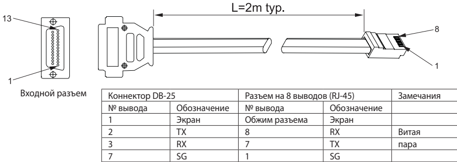
Рис. 7-2: Кабель RS232 с соединителем DB25 (P/N: Z/232-25)
