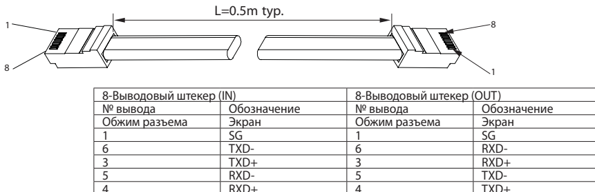
Рис.7-8: Последовательный соединительный кабель с экранированными соединителями RJ-45 (P/N: Z/RJ-45)
