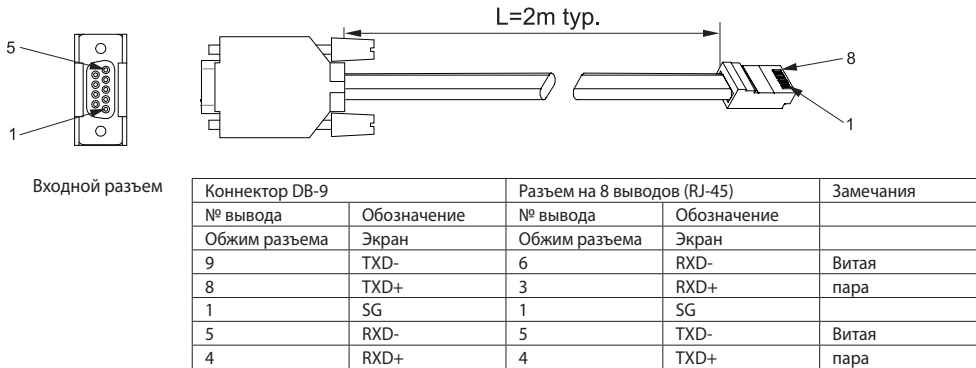
Рис. 7-4: Кабель RS485 с соединителем DB9 (P/N: Z/485-9)
