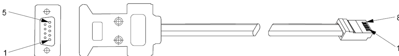
Рис. 5-7: Кабель RS485 с коннектором DB-9 – NC402
