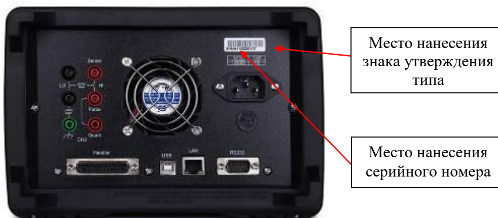
в) задняя панель источников-измерителей модификаций TH1992, TH1992A, TH1992B
