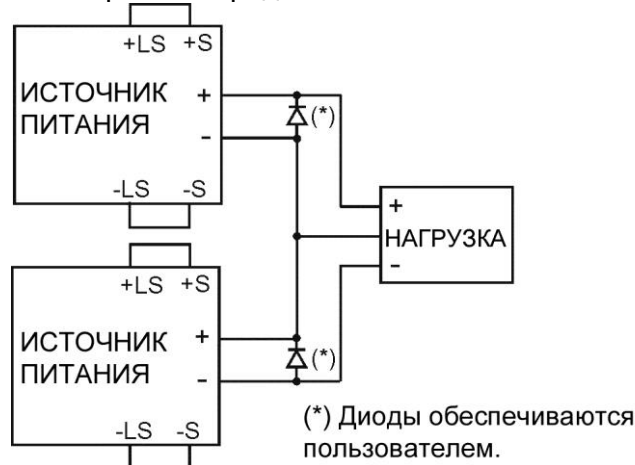
Рис.5-3: Последовательное соединение для получения положительного/отрицательного выходного напряжения
