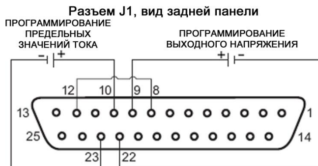
Рис.6-1: Подсоединение внешнего программирования уровнями напряжений
