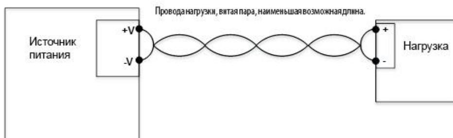
Рисунок 3–1: Подключение одиночной нагрузки, местная обратная связь
