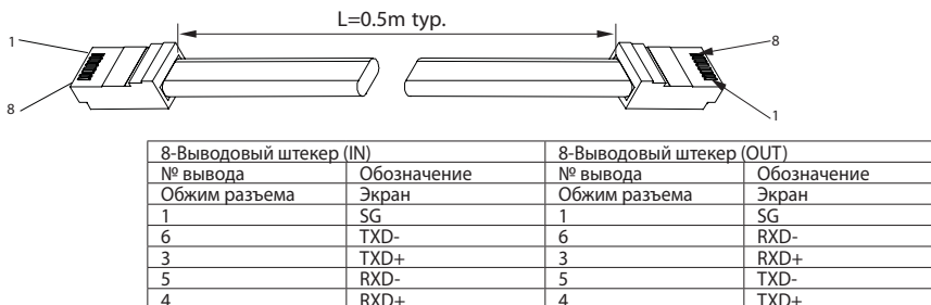
Рис.7-8: Последовательный соединительный кабель с экранированными соединителями RJ-45 (P/N: Z/RJ-45)
