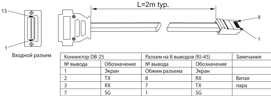
Рис. 7-2: Кабель RS232 с соединителем DB25 (P/N: Z/232-25)
