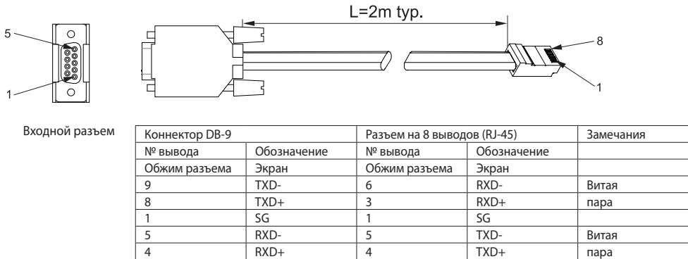
Рис. 7-4: Кабель RS485 с соединителем DB9 (P/N: Z/485-9)
