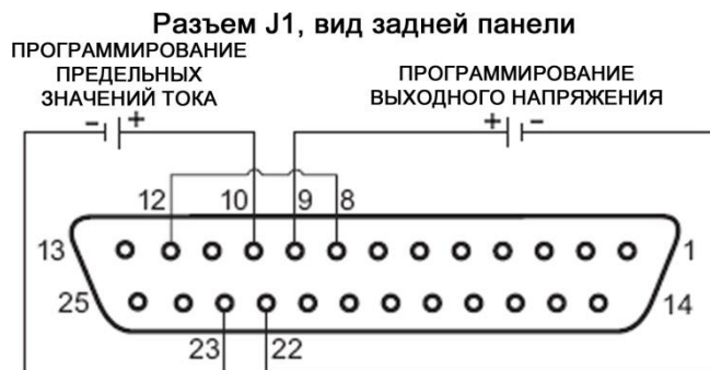
Рис.6-1: Подсоединение внешнего программирования уровнями напряжений
