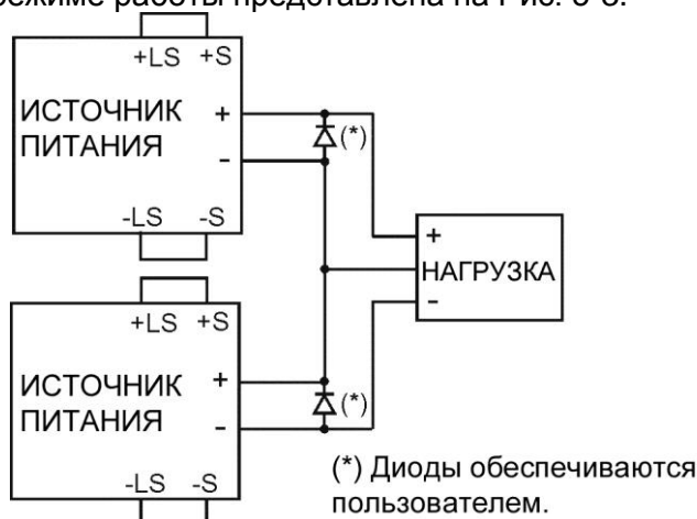
Рис.5-3: Последовательное соединение для получения положительного/отрицательного выходного напряжения
