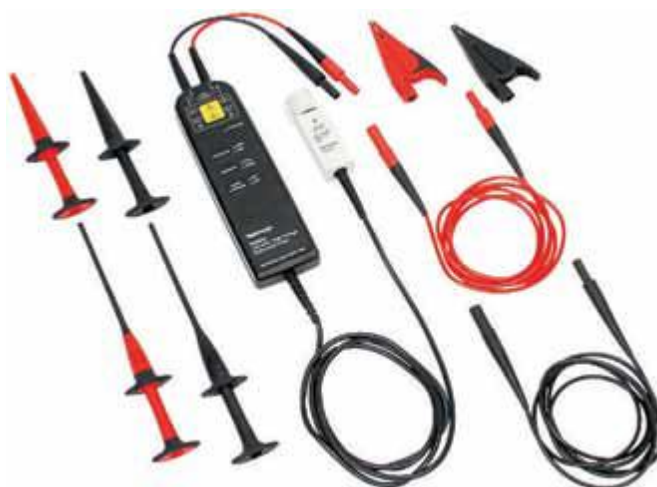
Рис. 4. Традиционный дифференциальный пробник с аксессуарами от компании Tektronix
