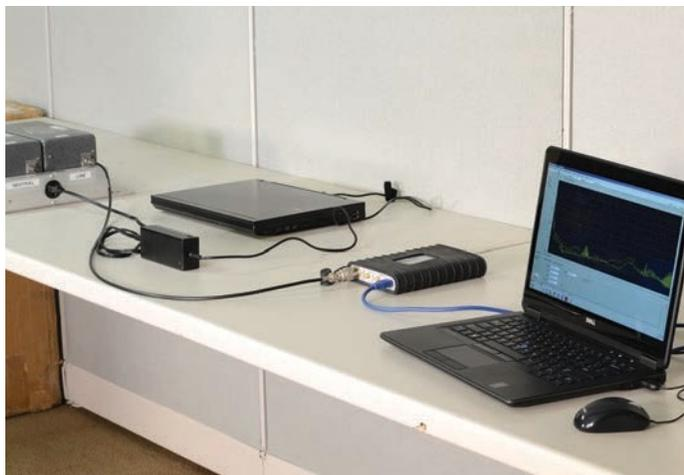
Рисунок 13. Тестовая установка для базовых предварительных измерений кондуктивного излучения.
